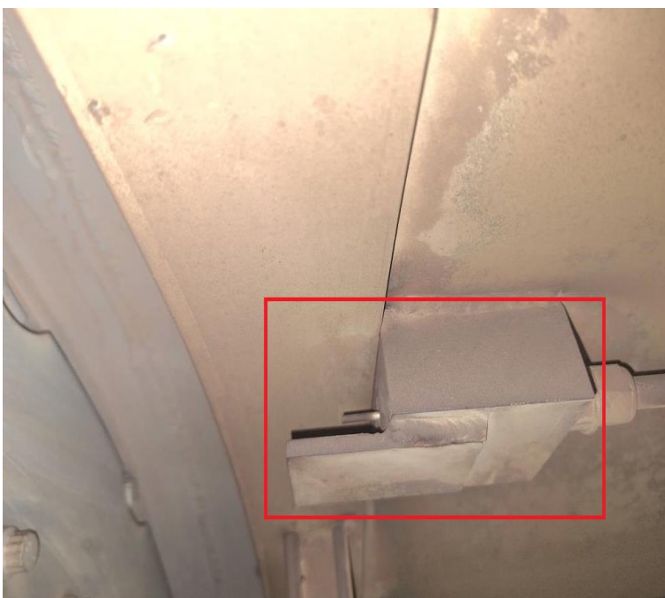
محل نصب سنسور TTIB، از نمای دور و نزدیک ( محدودده یاتاقان 3 )
